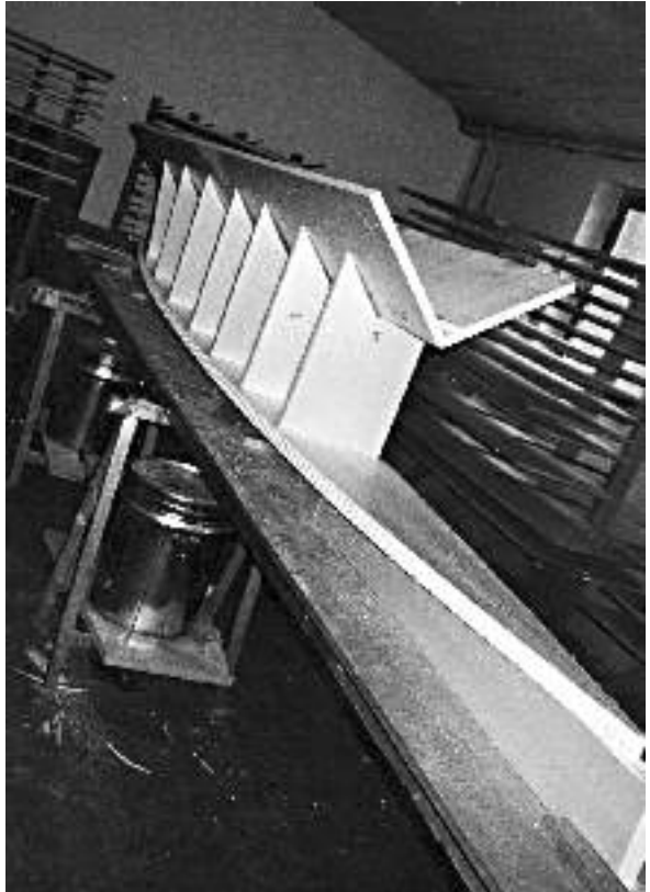
Boden, Spanten, Cockpit aufgelegt; rechts: Spaceframe wird angepaßt; Dachträger wird später abgesägt.
