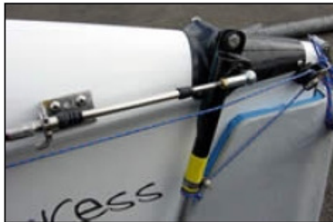
Bug einer Prowler-Moth mit sichtbarem Flughöhensteuerungsmechanismus.
